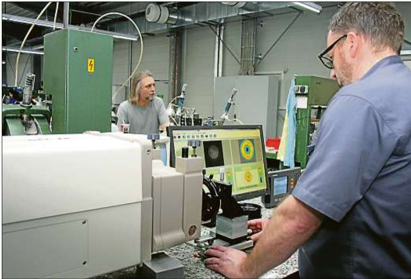
Auf Präzision kommt es an: Mitarbeiter von Meuser Optik überprüfen den Schliff der Linsen.
