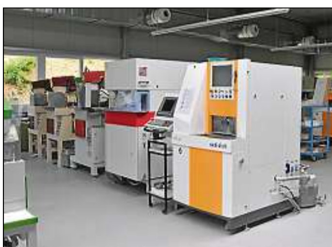
CNC-Fräsmaschinen und CNC-Poliermaschinen werden für die Fertigung hochgenauer Linsen eingesetzt.
