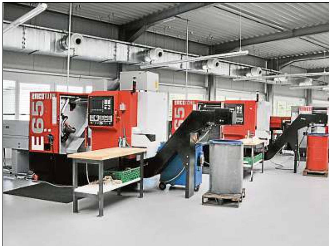
CNC-Drehmaschinen sorgen für die hochgenaue Bearbeitung von Fassungselementen und Werkzeugen der Meuser Optik GmbH. Es sind Durchmesser von fünf bis 350 mm möglich. Außerdem die Bearbeitung von zwei Seiten in einer Maschine.
