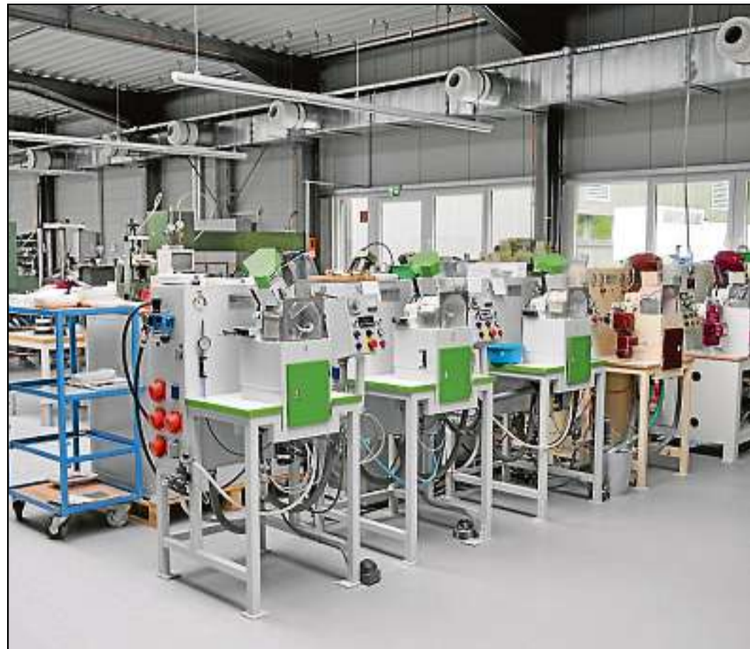
Moderne Poliermaschinen sorgen in der neu errichteten Produktionshalle für das Polieren von Einzellinsen optischer Linsen.
